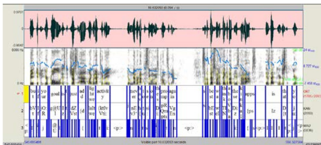
Abbildung 2: Ausschnitt aus einer Kombination von Sprachsignal (Oszillogramm und Spektrogramm, oben) und Annotationsdatei (unten) des Sprechers Mark Zuckerberg.
